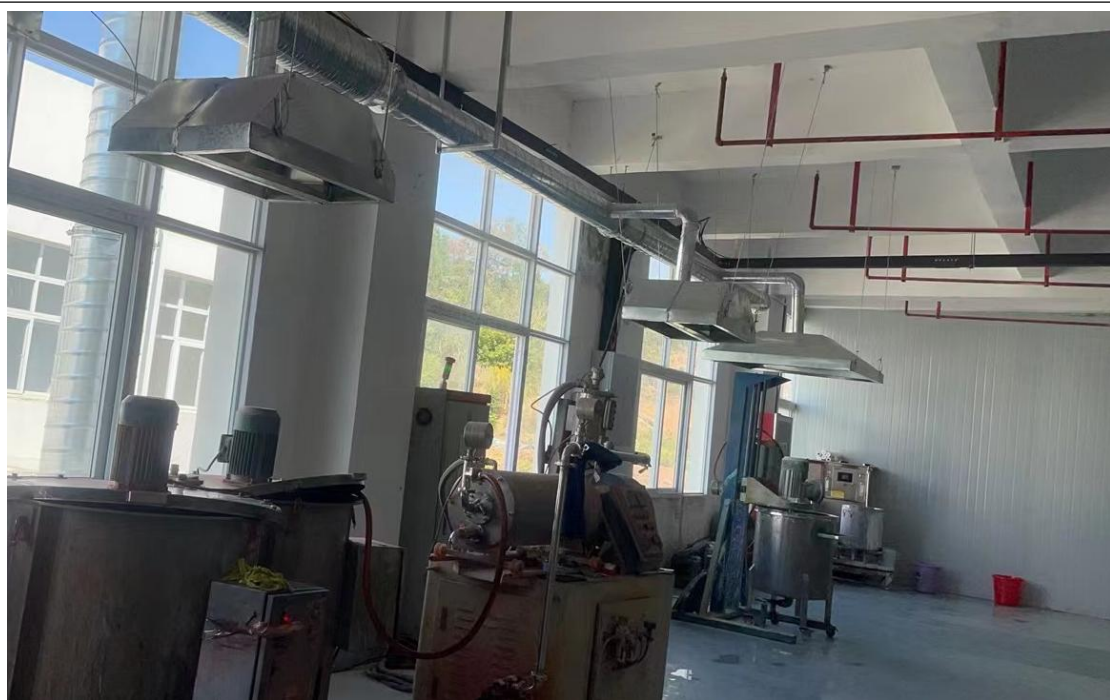
墨水调配间封闭生产+集气罩收集
