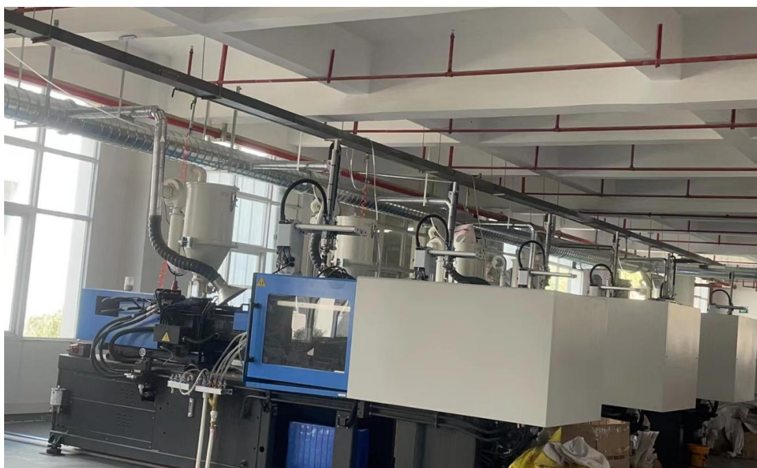
注塑车间封闭加工+集气罩收集
