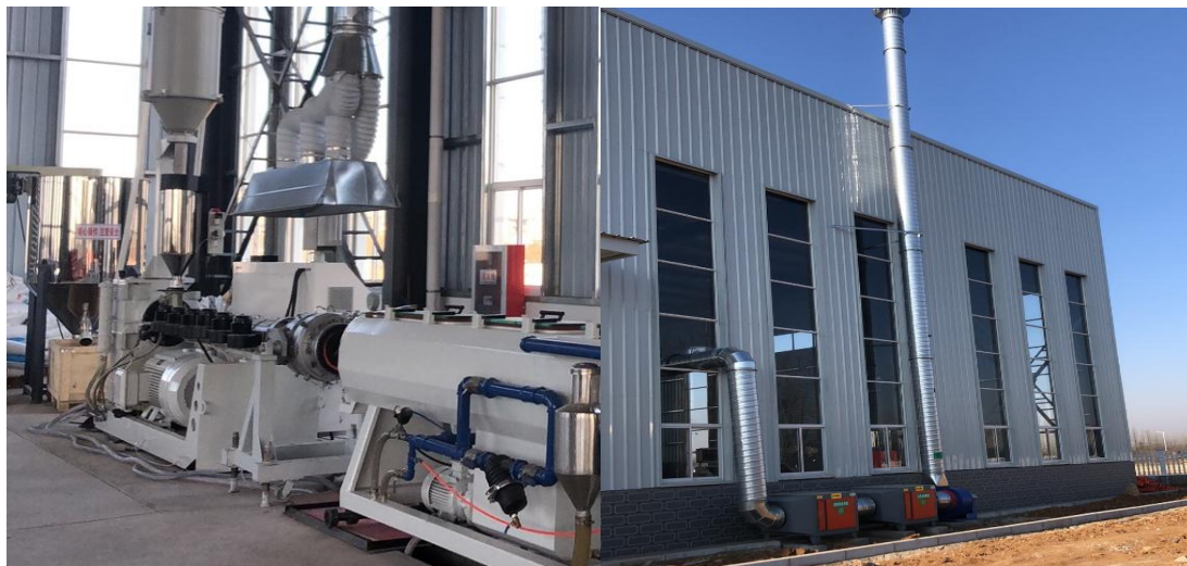
挤塑有机废气：集气罩+两级活性炭吸附装置+15m 高排气筒
